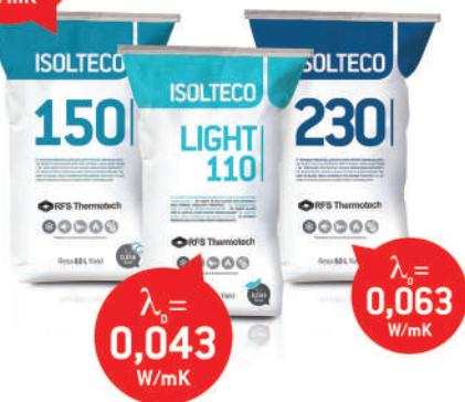
اندود ایزولتکو، ملات خشک فوق سبک و آماده ایست با رسانایی بسیار کم که از ترکیب و مخلوط نمودن دانه های فرآوری شده EPS باردار و پوشش داده شده به همراه سیمان و افزودنی های خاص، تشکیل شده است. اندود عایق حرارتی ایزولتکو برای سیستم دیوارهای خارجی، عایق کاری بین دیوار دو جداره و سقفها به عنوان عایق حرارتی استفاده می شود. استفاده از این محصول موجب درزبندی صوتی و عایق کاری حرارتی کامل، حذف پل های حرارتی و تامین الزامات مبحث ۱۹ مقررات ملی ساختمان می گردد.
